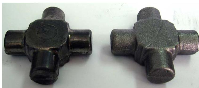
*Slika 25 – Izgled otkovaka kardanskog krsta dobijenih orbitalnim kovanjem (levo) i toplim kovanjem (desno)*
