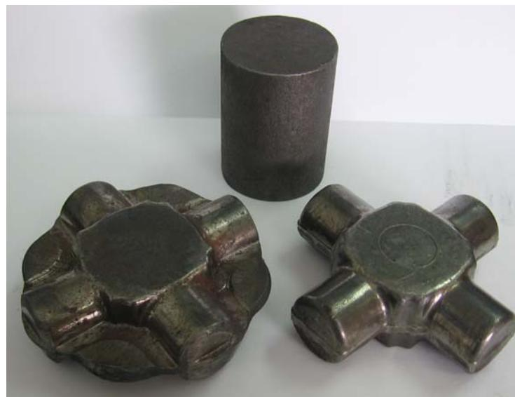
*Slika 24 – Otkovak kardanskog krsta po fazama izrade dobijen hladnim orbitalnim kovanjem*
