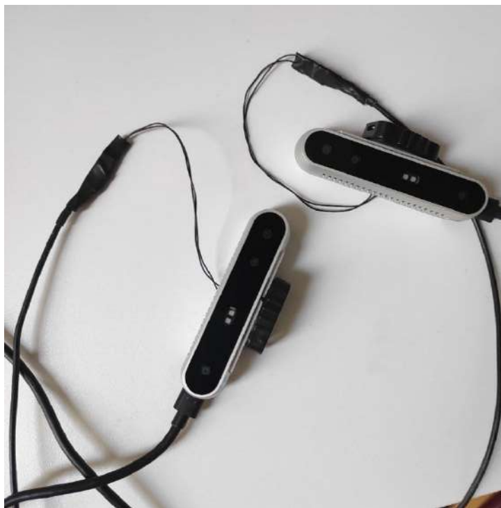
Слика 3.5 – Конфигурација пара Intel RealSense D415 RGB-D камера са успостављеном хардверском синхронизацијом. Камере су одабране за реализацију касније експерименталне фазе у истраживању, тј. Експеримента 2 и 3.
