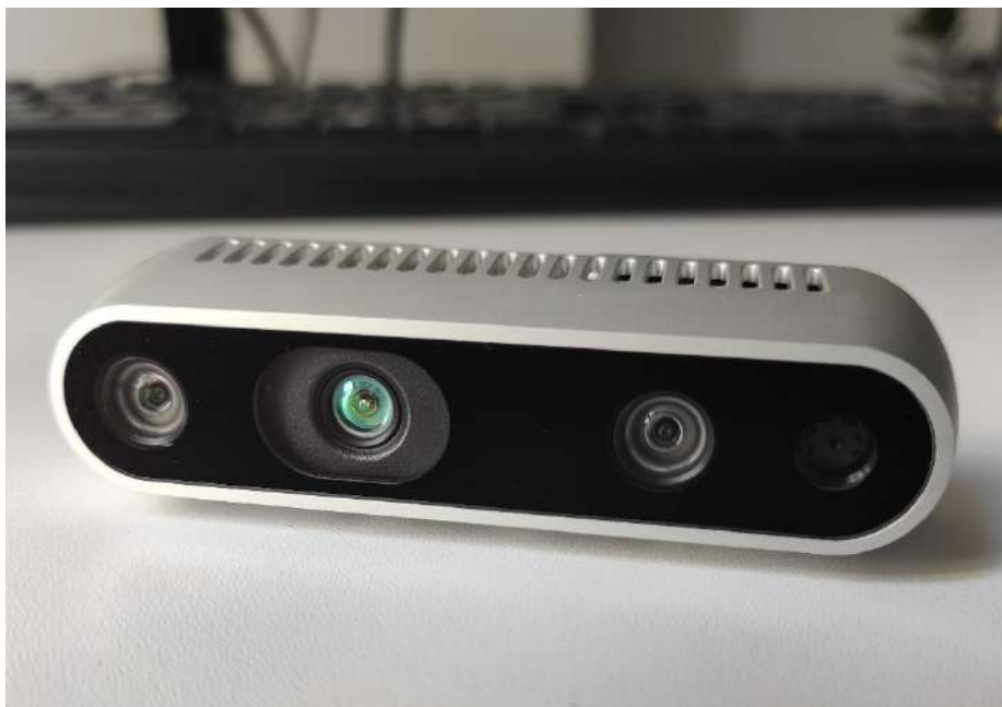
Слика 3.4 – Камера D435i , један од представника серије D400 , базирана на технологији активне стереовизије. Ова камера је коришћена у првој фази истраживања.
