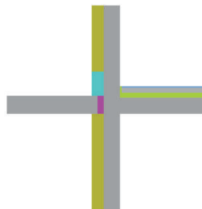
Slika 4. Detalj 1c, prekid toplinskog mosta TB3
