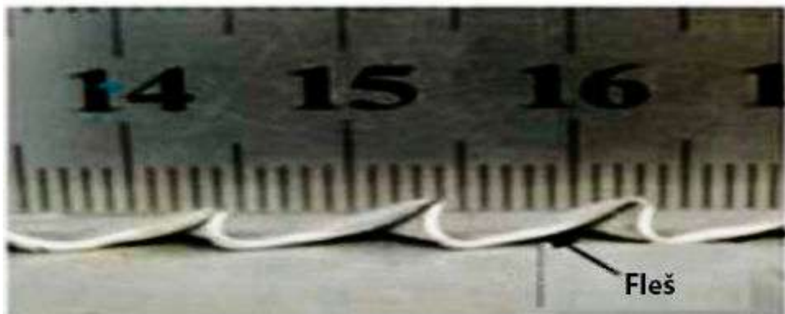
Slika 55. Fleš nastao u toku postupka zavarivanja [9]
