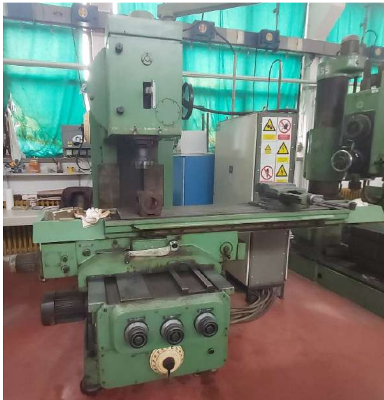
Slika 75. Vertikalna glodalica Prvomajska FSSGVK-3
