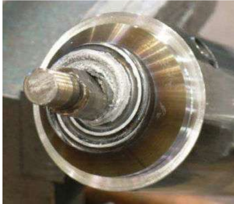
Slika 51. Prikaz akumulacionog zagušenja alata ( akumulacija materijala na gornjem ramenu alata ) [86]
