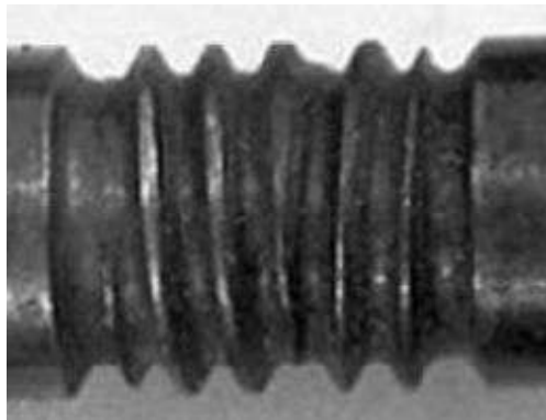
Slika 33. Prikaz trna sa dvostrukim navojem [57]
