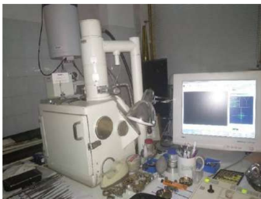
Slika 79. Skenirajući elektronski mikroskop JEOL JSM 6460LV
