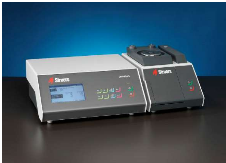
Slika 89. Uređaj za elektrolitičko nagrizanje Lectropol-5 Automatic [131]
