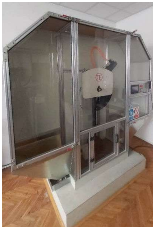
Slika 96. Instrumentirano Šarpijevo klatno JWT-450
