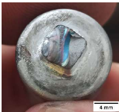
Slika 85. Prikaz prelomljenog alata
