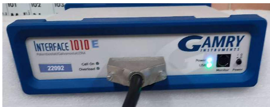
Slika 98. Uređaj za elektrohemijsko ispitivanje
