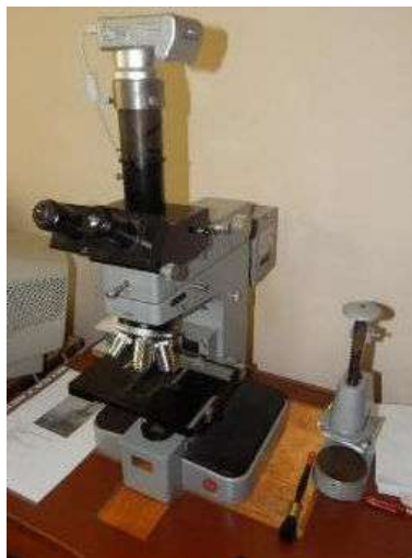
Slika 78. Svetlosni mikroskop Leitz Orthoplan
