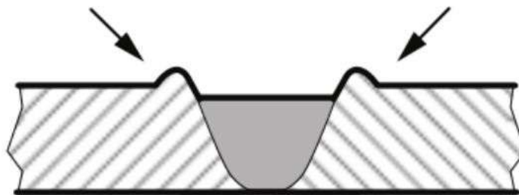
Slika 20. Šematski prikaz istisnutog materijala [53]
