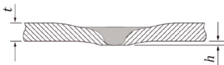
Slika 22. Prikaz deformacije zone spoja [53]
