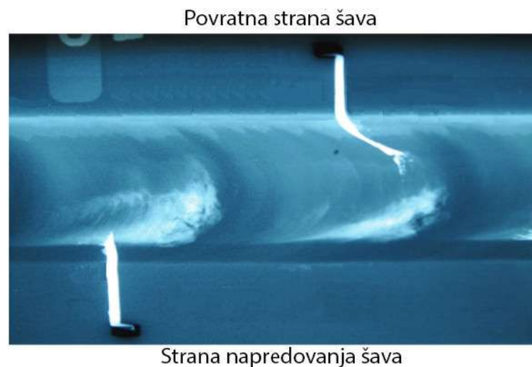
Slika 48. Rendgenski snimak zavarenog spoja sa vertikalnom orijentacijom folije [84]
