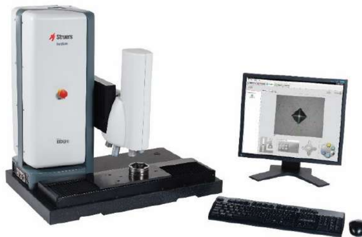
Slika 95. Uređaj za merenje mikrotvrdoće Struers DuraScan 70 [134]
