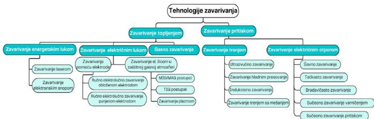
Slika 5. Podela postupaka zavarivanja [25]
