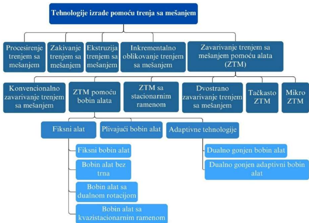
Slika 8. Prikaz podele postupaka zavarivanjem trenjem sa mešanjem [11,36]
