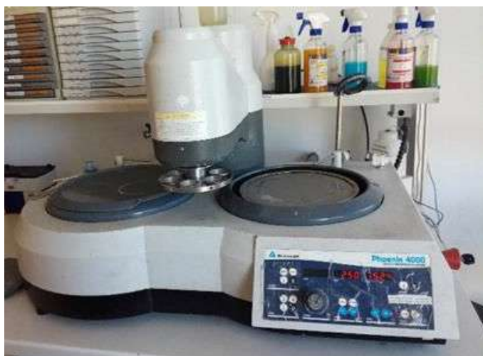
Slika 87. Uređaj za brušenje i poliranje Buheler Phoenix 4000
