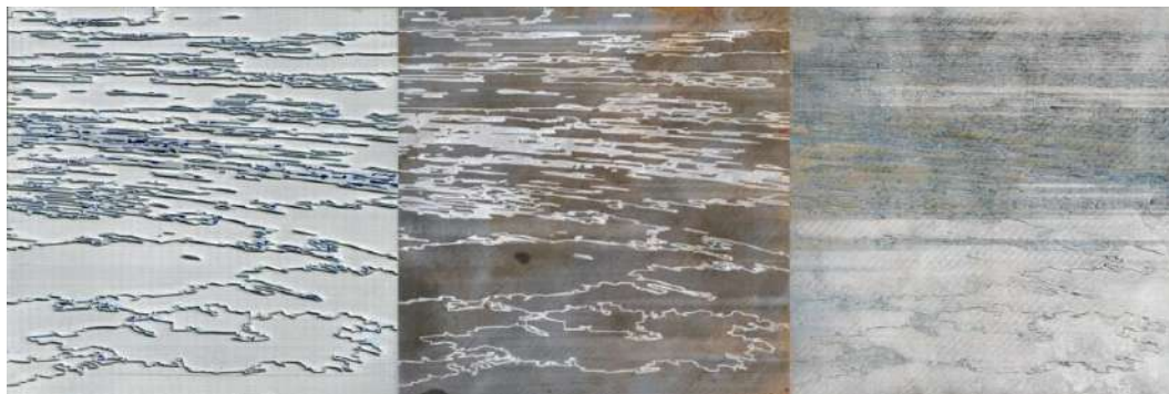
Ilustracija 19: Probe prenosa crteža na različite materijale (gumu, čelični lim i inoks), 2026.
