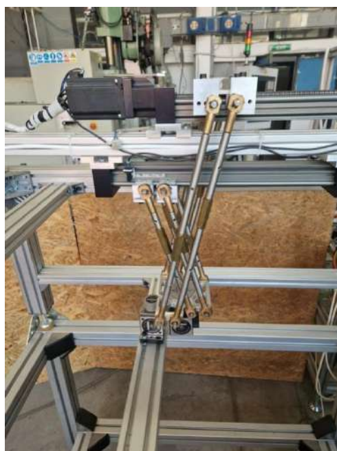
Слика 12-3. Механизам са мерном оптиком током провере X осе
