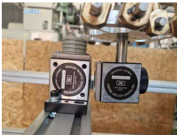
Слика 12-2. Ретрорефлектор и интерферометар у нултој позицији мерења током провере X осе
