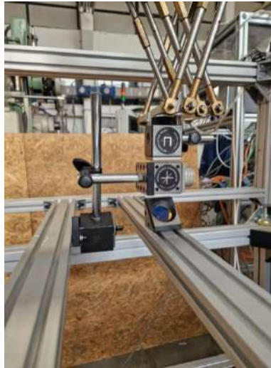
Слика 12-11. Поставка мерних оптичких компоненти за проверу тачности позиционирања Z осе (EZZ)
