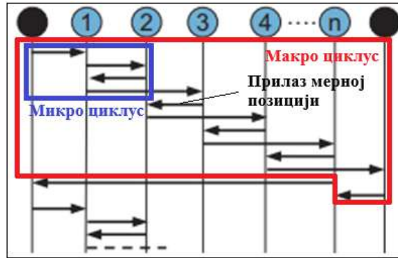
Слика 13-1. Приказ микро и макро циклуса кретања платформе при методи ходочасника (дорађено [16])
