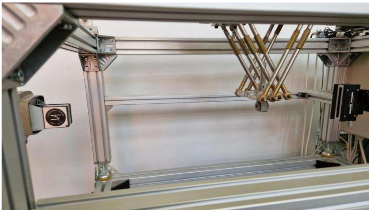
Слика 10-3. Поставка ласерске мерне инструментације за проверу одступања правости X осе у правцу Z осе (EZX)
