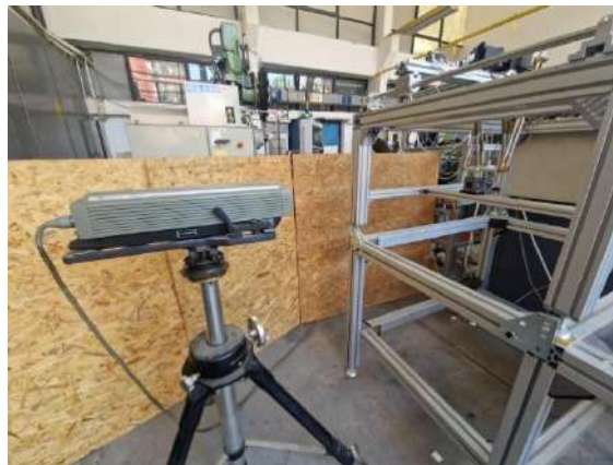
Слика 12-1. Постављена мерна опрема за проверу тачности позиционирања X осе
