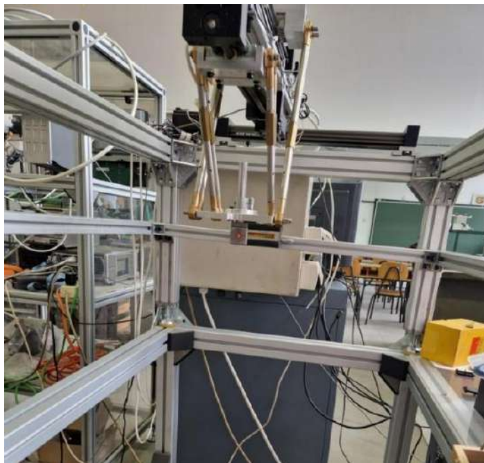
Слика 10-2. Поставка ласерске мерне инструментације за проверу одступања од правости X осе у правцу Y осе (EYX)
