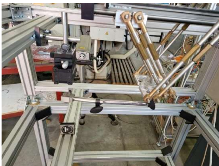
Слика 10-1. Поставка ласерске мерне инструментације за проверу одступања од правости Z осе у правцу Y осе (EYZ)
