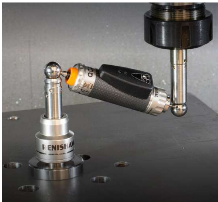
Слика 3-11. Комплет Renishaw ballbar QC20 [67]
