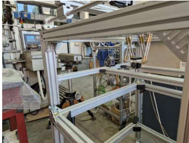
Слика 12-7. Поставка мерне инструментације за проверу тачности позиционирања Y осе (EYY)
