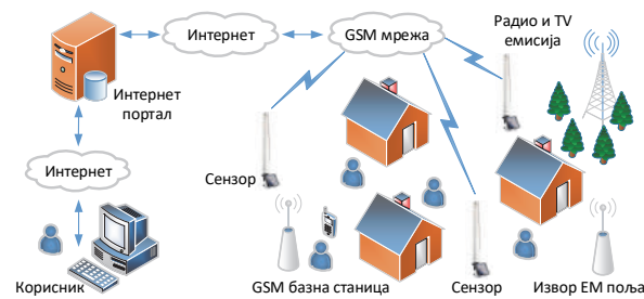
Слика 1. Концепт увезивања сензора за мониторинг ЕМ поља.
