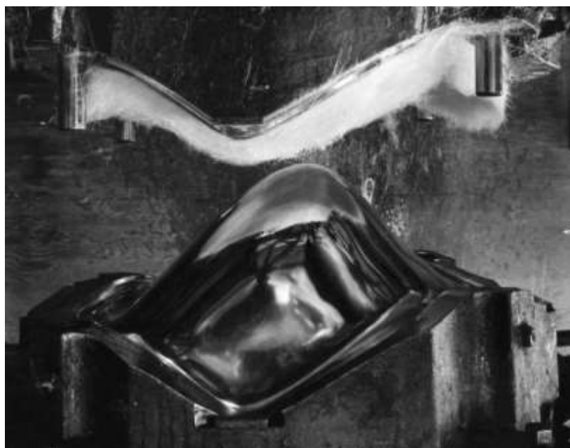
Слика 25: Eams Fiberglass Chair / Charles & Ray Eams, Vitra, 1950. година. Наношење фибергласа преко модела
