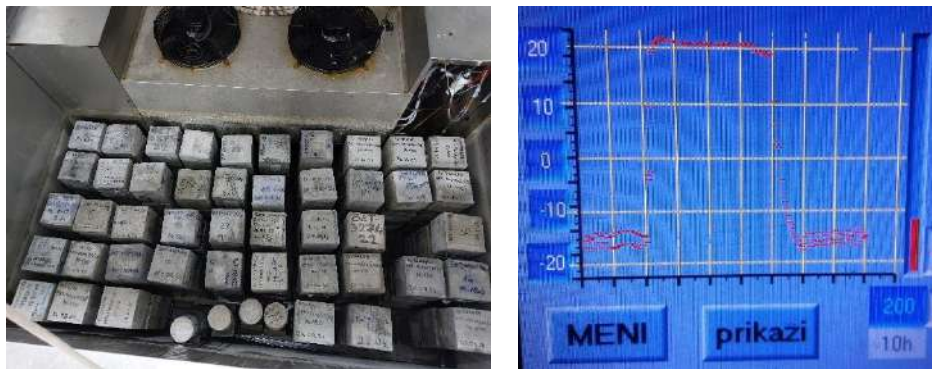
Слика IV-17 а) Узорци бетона у комори за испитивање отпорности бетона на мраз, б) Режим испитивања једног циклуса замрзавања и одмрзавања
