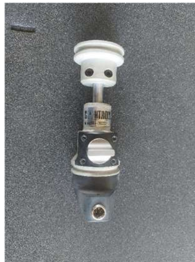
Слика IV-24 – Индуктивни претварач (екстензометар), осетљивости 0.02( \mu\text{m} )
