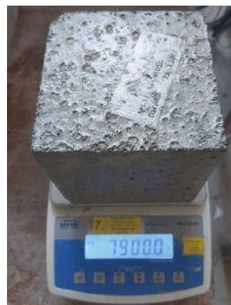
Слика IV-13 - Мерење димензија бетонских узорака и мерење масе узорка у водом засићеном стању
