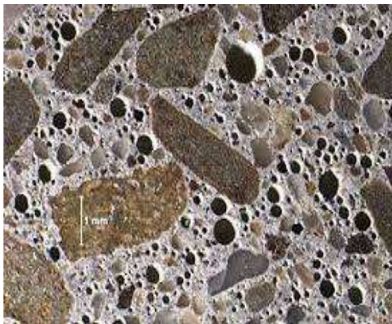
Слика I-1- Изглед сферичних пора ваздуха у цементном камену које ствара аерант
