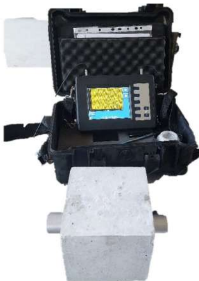
Слика IV-21 – Ултразвучни апарат високих перформанси, произвођача „Impact Test Equipment“ – Engleska.
