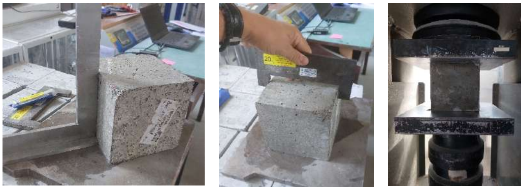
Слика IV-14 - Одређивање чврстоће бетона при притиску
