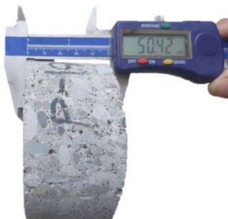
Слика IV-25 – Дигитално кљунасто мерило дужине „MIB“ – Немачка, мерног опсега до 150 mm
