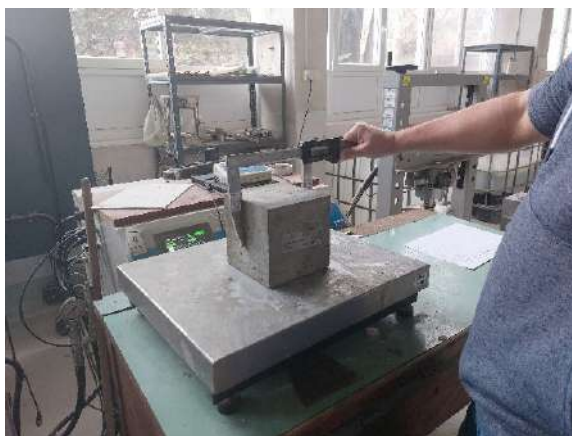
Слика IV-13 - Мерење димензија бетонских узорака и мерење масе узорка у водом засићеном стању
