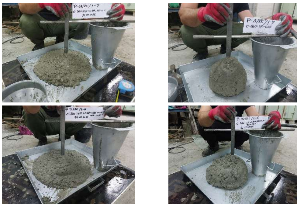
Слика IV-10 - Мерење конзистенције (методом слијегања) за бетоне P-1, P-3, P-7 и P-10
