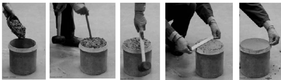
Слика VIII-2 - Поступак мерења запреминске масе свежег бетона
