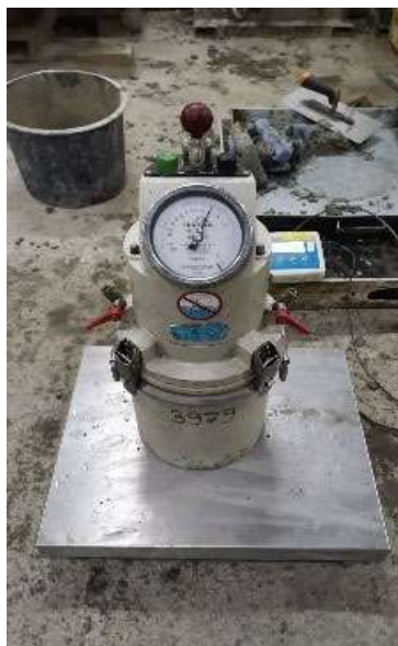
Слика IV-12 – Одређивање садржаја ваздуха у свежем бетону помоћу порозиметра Testing – Немачка
