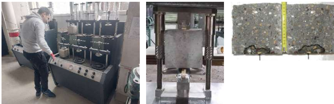
Слика IV-16 – Апаратура за испитивање, цепање узорак и мерење дубине продирање воде
