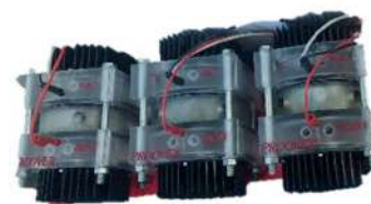
Слика IV-26 – Уређај за наношење напона „Proove'it“, произвођача „Germann Instruments“ – Немачка, опсег напона од 5 до 60 V
