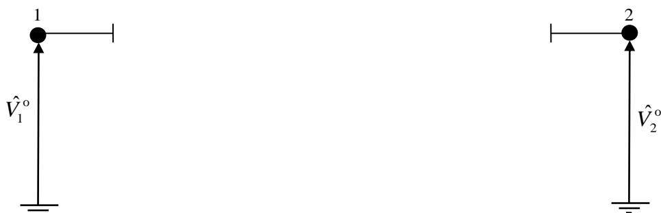
Слика 4.3.5 – Погонска кола трофазних двонамотајних трансформатора за симетричне режиме нултог редоследа за све спрегне типа Dd [69].
