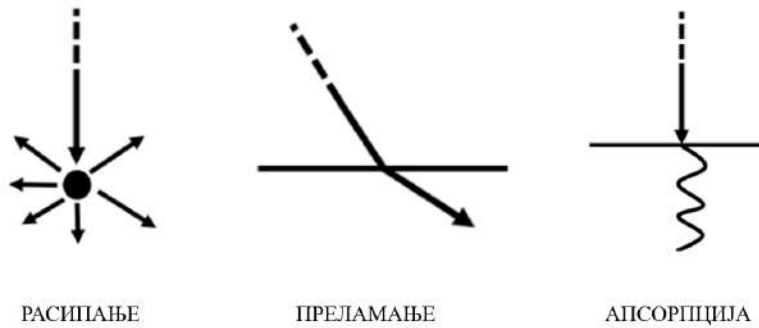
Слика 29: Графички приказ расипања, преламања и апсорпције
