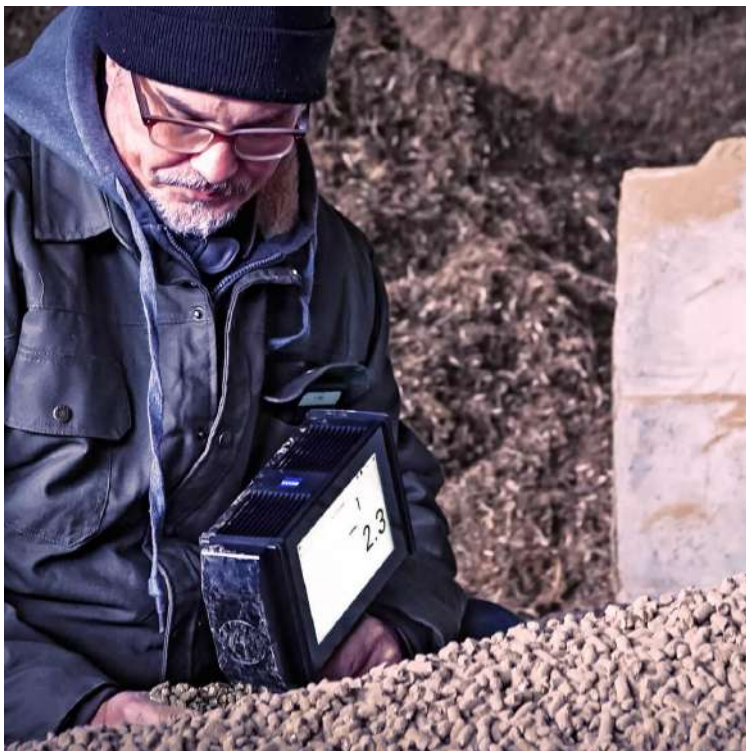
Слика 38: Мобилни уређај за NIR спектроскопију[147]
