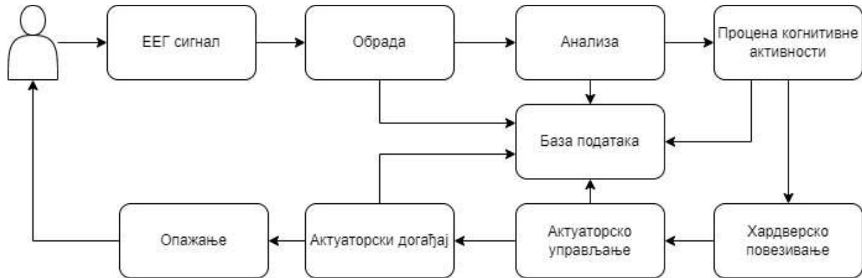
Слика 40 Архитектура неурофидбек актуатора
