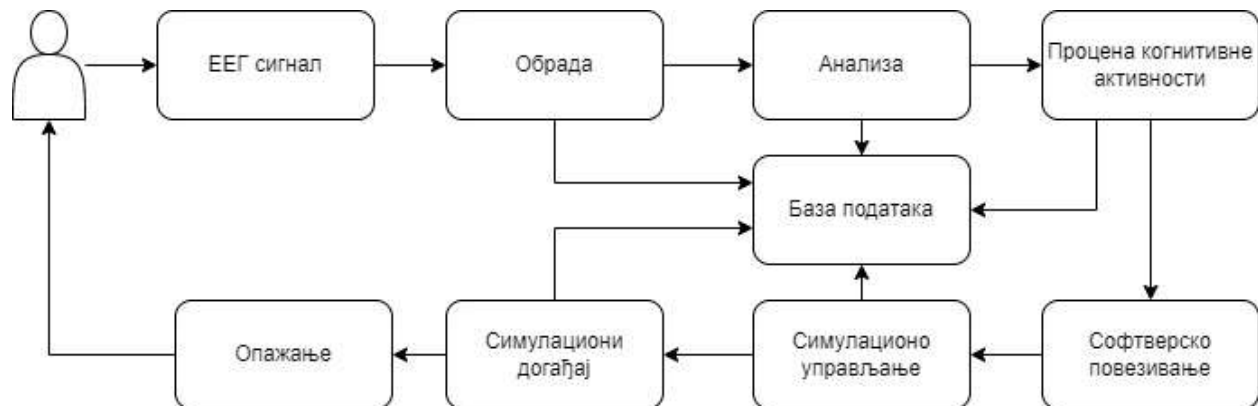
Слика 33 Архитектура неурофидбек симулатора
