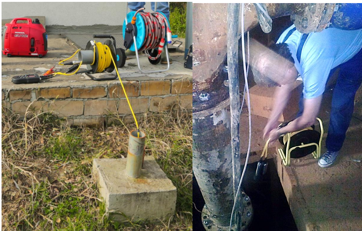
Слика 11 In-situ мерење физичко-хемијских параметара воде (пијезометар и шахт бунара са хоризонталним дренажима)
