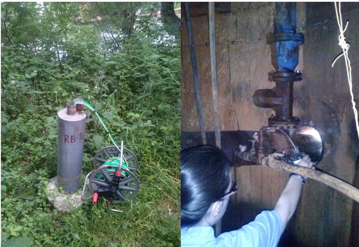
Слика 12 Узорковање подземне воде (из тијезометра коришћењем пумпе и у шахту бунара са хоризонталним дренажима са славине за узимање узорка)
