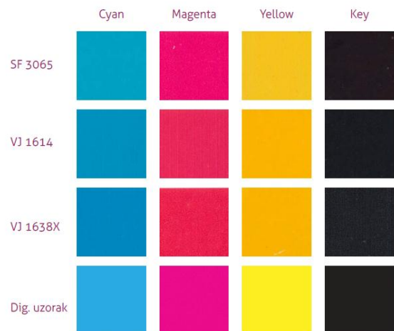
Slika 6. Uporedni prikaz skeniranih uzoraka sa tri štamparska sistema i digitalni uzorak kao referenca
