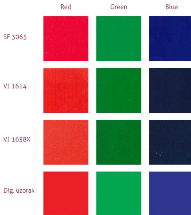
Slika 10. Uporedni prikaz skeniranih uzoraka sa tri štamparska sistema i digitalni uzorak kao referenca
