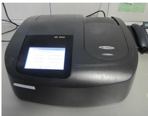
Sl. 2 UV/Vis Spektrofotometar DR 5000 uređaj korišćen pri analizi vode konvencionalnim metodama
