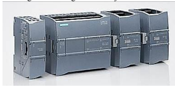
Slika 3. Primer PLK kontrolera – SIMENS [1]
