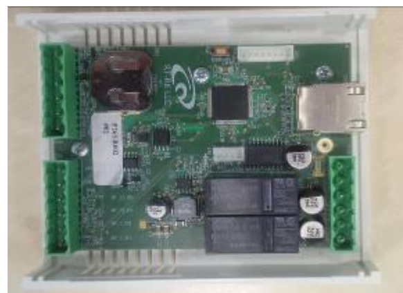
Slika 4. Slika realizovanog pametnog čitača sa IP konekcijom.
