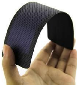
Slika 3.1. Izgled fleksibilne solarne ćelije
