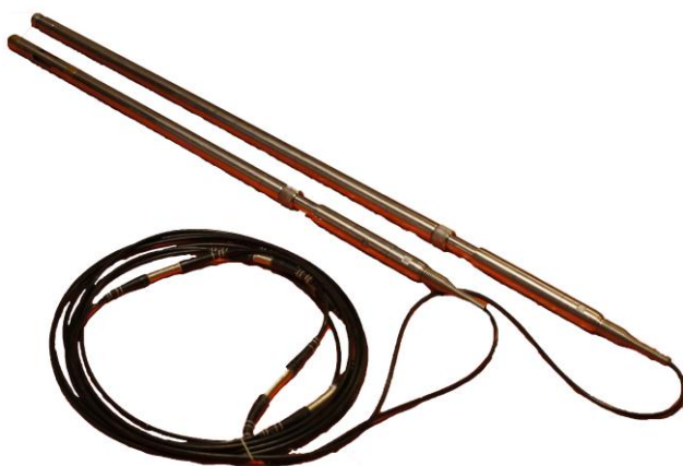
Slika 8. Elektrolog i gama sonda – konačna realizacija uređaja za GFK merenja
