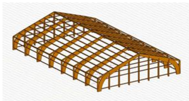
Slika 1. Elementi hale od LLD – izometrijski prikaz
