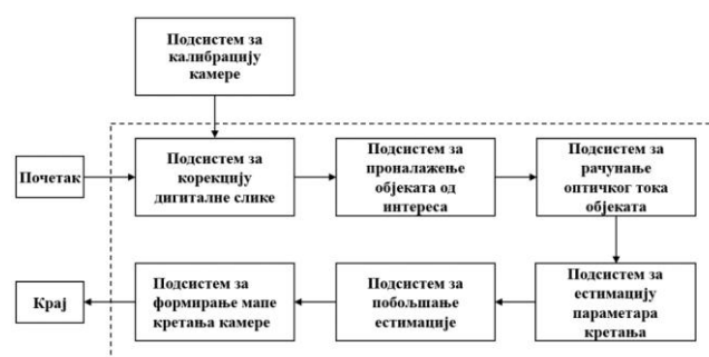
Slika 1. Konceptualni dijagram sistema
