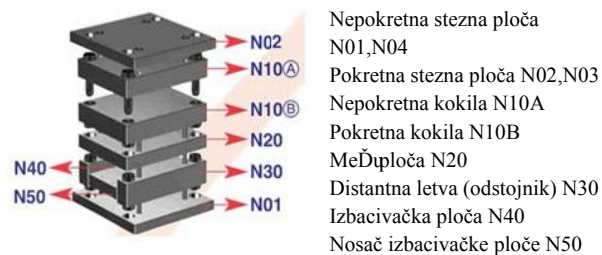
Slika 4. Standardno kućište alata za injekciono presovanje plastike
