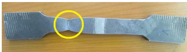
Slika 7 Prelomljena epruveta za ispitivanje zatezanjem
