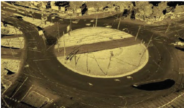
Slika 7. Oblak tačaka prikupljen laserskim skeniranjem lokacija Autokomanda
