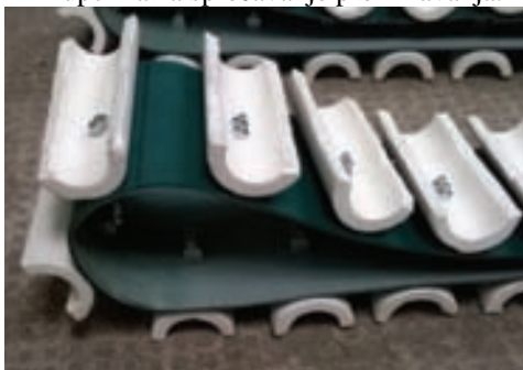
Slika 3.1. Gusenice sa pogonskim zupcima (na unutrašnjosti gusenice) i plastičnim zupcima (pričvršćenim sa spoljašnje strane gusenice).
