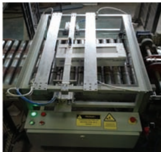
Slika 7. Izgled realizovanog manipulatora postavljenog na pokretnoj traci u firmi „Zorka keramika“ u Šapcu
