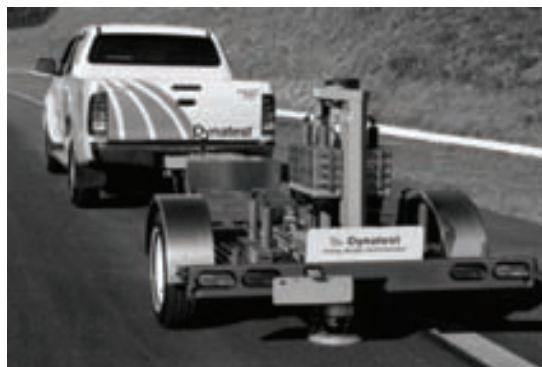
Слика 1. FWD ( Falling Weight Deflectometer ) мул DYNATEST
