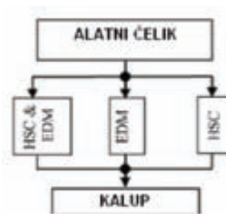
Slika 1. Načini izrade alata za brizganje plastike
