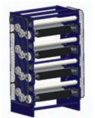
Slika 3. Konstrukciono rešenje modula za fleksu štampu
