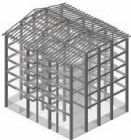
Slika 2. 3D Izgled konstrukcije
