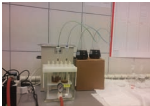
Slika 2. Propuštanje uzorka kroz kolone C18
