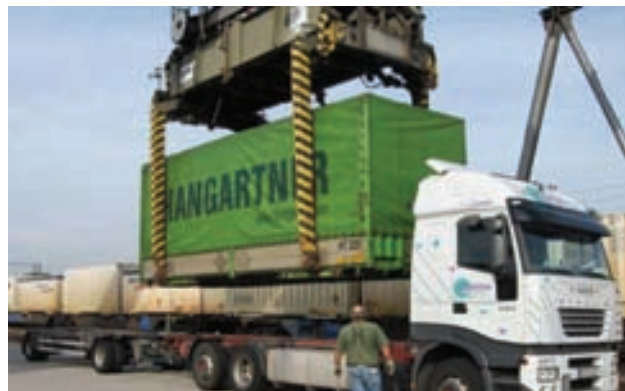
Slika 4. Pretovar izmenjivog transportnog suda pomoću dizalice
