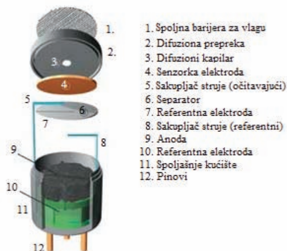
Slika 3. Konstrukcija elektrohemijskog senzora
