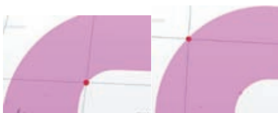
Slika 3.2 Položaj senzora pritiska na mernom kolenu
