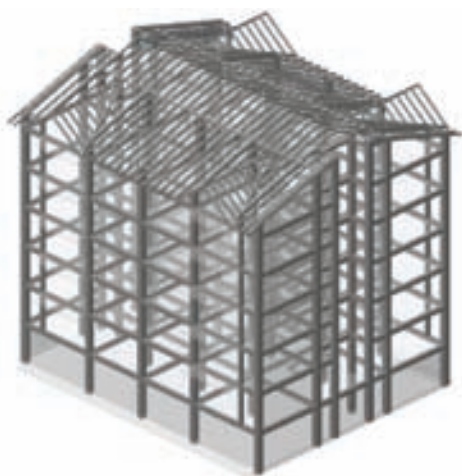
Slika 2. 3D Izgled konstrukcije
