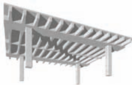
Slika 2. Primer konstrukcije sitnorebraste tavanice
