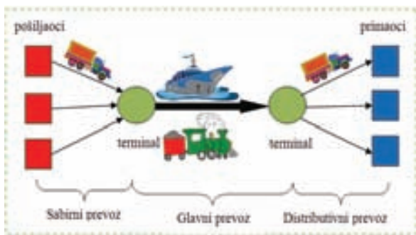
Slika 1. Najjednostavniji oblik kombinovanog transportnog lanca
