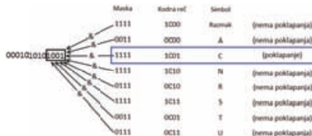
Slika 5. Poređenje podataka sa ulaza sa svim mogućim kodnim rečima
