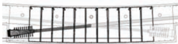
Slika 9. Presek kroz ankerski blok cilindričnog zida
