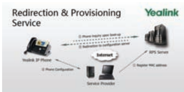
Slika 4. Princip rada Yealink servera za automatsko konfigurisanje telefona
