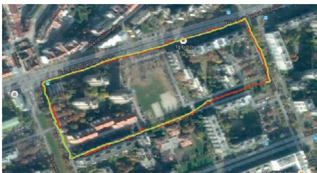
Slika 4: Apsolutna kinematička metoda merenja GPS (crveni) i GNSS (zeleni) poligon
