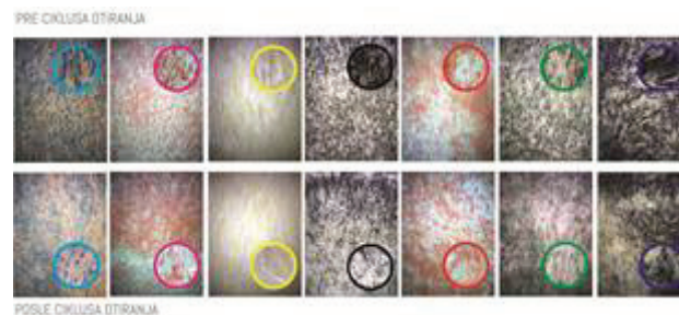
Slika 11. Mikroskopski prikaz trećeg uzorka pre ciklusa otiranja (gornji red) i nakon ciklusa otiranja (donji red))
