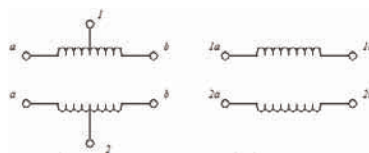
Sl. 7. Izgled namotaja unipolarnog (levo) i bipolarnog (desno) koračnog motora
