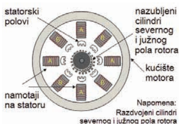
Sl. 5. Izgled dvofaznog hibridnog koračnog motora
