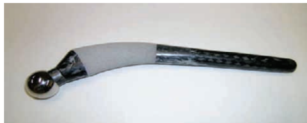
Slika 4. Proteza kuka od kompozitnog biomaterijala [4]
