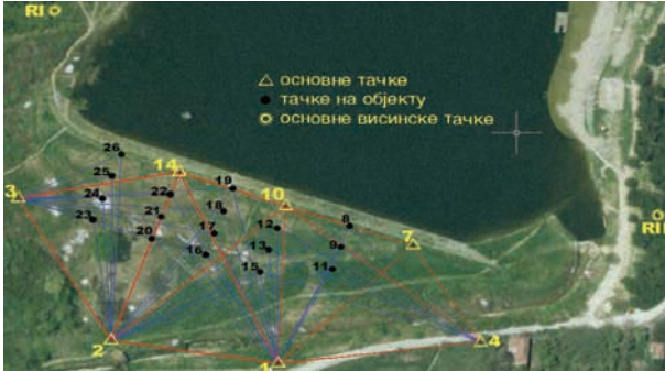
Слика 3. Успостављена геодетска мрежа
