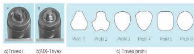
Slika 2. Različiti oblici geometrije Trivex alata [3].
