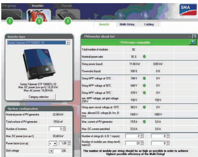
Slika 4. Prikaz primene Sunny Design programa - prozor za izbor invertora sa prikazom proračunatih parametara
