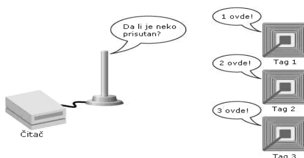
Slika 1. Način na koji tag obaveštava čitač o svom prisustvu
