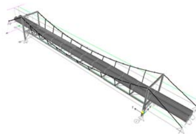
Slika 5 – Model mosta izrađen u SAP-u 2000
