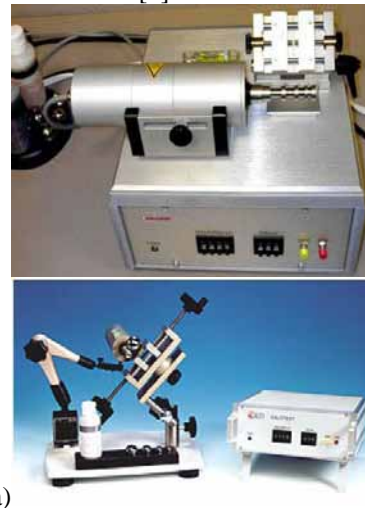
Slika 2.6: Vrste kalotest uređaja : a) kompaktni kalotest, b) industrijski kalotest
