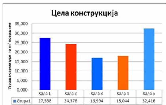
Slika 5. Utrošak armature za celu konstrukciju
