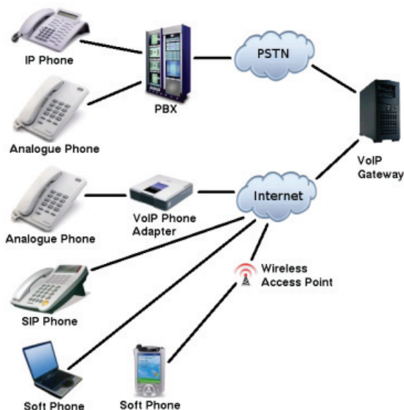
Slika 1. Shematski prikaz klasične i VoIP telefonije
