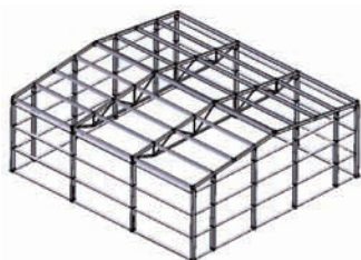
Slika 2.3. Postavljanje preostalih rožnjača, bočnih i frontalnih nosača obloga
