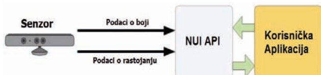
Slika 3.2 Interakcija između Kinect-a i korisničke aplikacije
