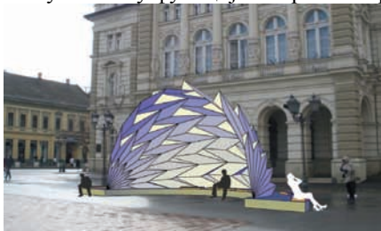
Слика 9. Предлог склопиве полукуполе
