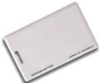
Slika 5. RFID tag u obliku kartice
