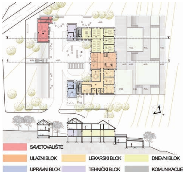
Slika 8. Osnova prizemlja i presek objekta
