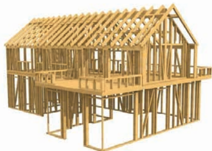
Slika 2. Skeletni način gradnje
