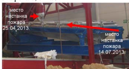
Slika 9. Sito za prosejavanje mesno koštanog brašna, označena mesta požara
