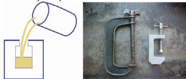
Slika 1. Popunjavanje šupljine rastopljenim metalom (levo) i ručna stega izrađena livenjem i rezanjem (desno)
