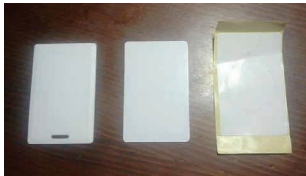
Slika 6. Izgled tagova u tri izvedbi: Clamshell, kreditna kartica (ISO/IEC 7810), samolepljiva etiketa, respektivno.
