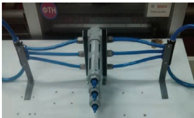
Slika 5.6. Sistem sa tri paralelno vezana čestična MINI filtera
