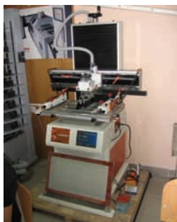
Slika 2. Prikaz mašine za sito štampu S550 TSH print Swiss
