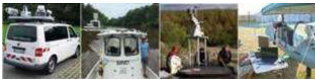
Слика 2. Платформе за мобилно ласерско скенирање
