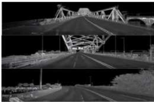
Слика 5. Облак тачака моста The Silver Jubilee Bridge
