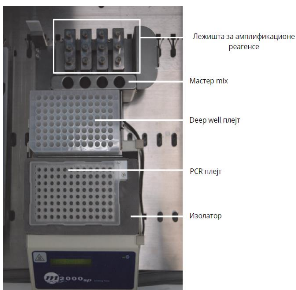
Slika 8. Postolje sa ležištima, odozgo [4]
