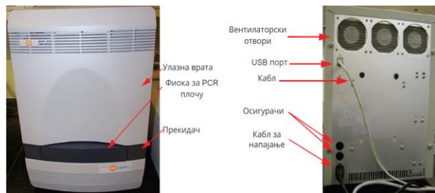
Slika 9. Prednja i zadnja strana dela za PCR reakciju [5]
