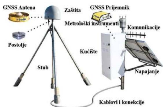
Слика 2: Основне компоненте перманентне станице
