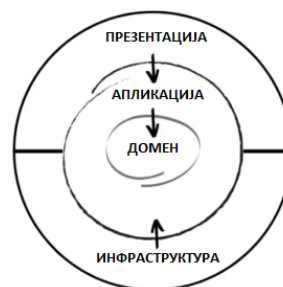
Слика 2.2.2. - Илустрација “ Onion ” архитектуре
