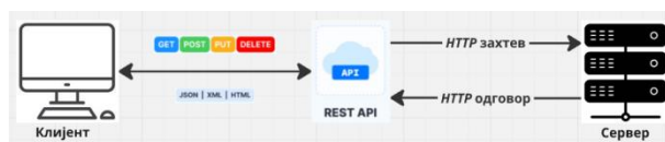
Слика 2.2.1. - “ REST ” принцип комуникације клијентске и серверске апликације
