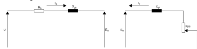
Слика 1. Пофазна представа асинхроне машине
