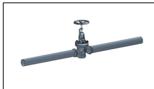
Slika 3. Model ventila i ravne cevne deonice
