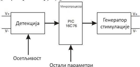
Слика 3. Приказ једноставне имплементације ВВИ пејсмејкера
