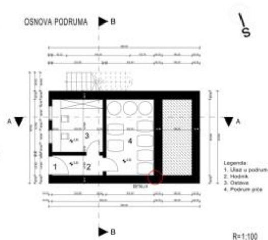
Slika 9. Osnova podruma (novonastalo stanje)
