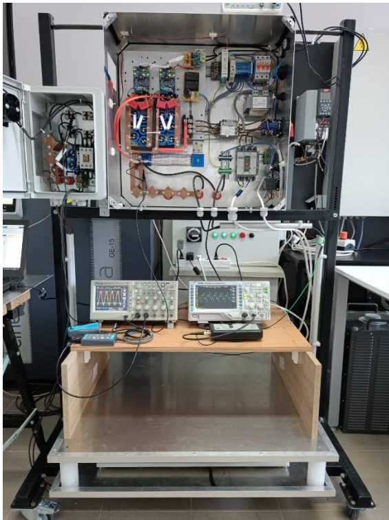
Слика 2. Реализовани систем за бежични пренос електричне енергије
