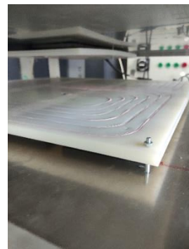
Слика 5. Спрегнути калемови (доњи калем је предајни док је горњи пријемни)
