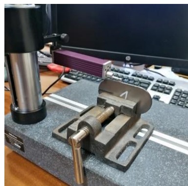
Slika 3. Prikaz merenja površinske hrapavosti uzorka na instrumentu Mitutoyo surfest SJ-210
