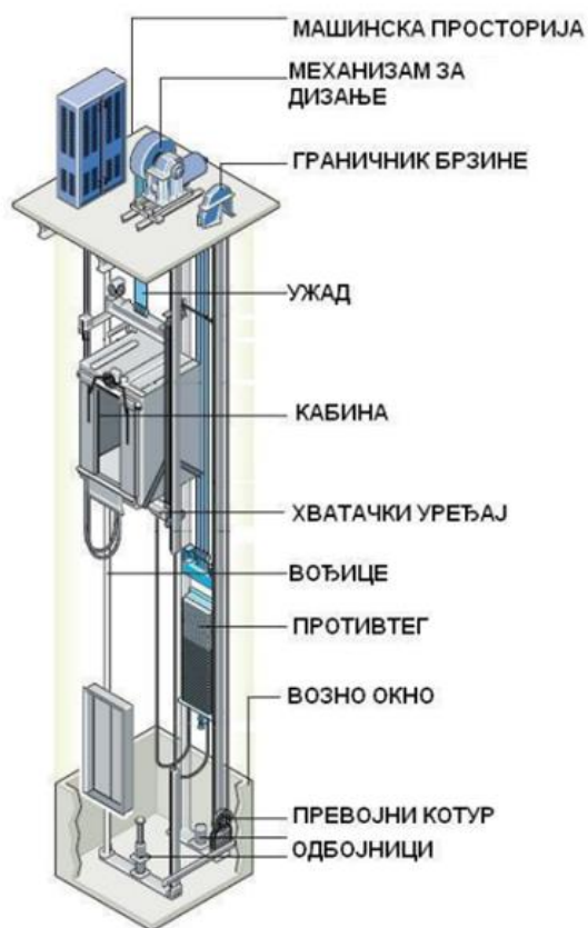
Слика 1. Основне компоненте електричних лифтова [3]
