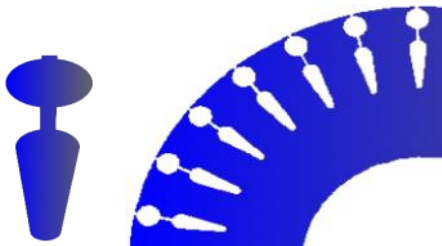
Слика 5 – Изглед жлеба и једног дела лима ротора
