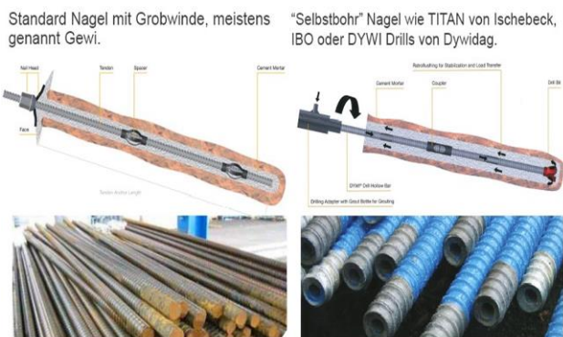
Слика 5: Анкер и такозвани „самобушени“ анкер [3]
