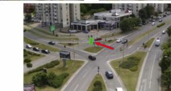
Slika 8. Primer greške praćenja (preuzimanje) bicikliste usled kratkotrajne okluzije, preklapanja sa pešakom
