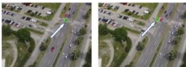
Slika 10. Uspešno praćenje pešaka pri delimičnoj okluziji usled semafora
