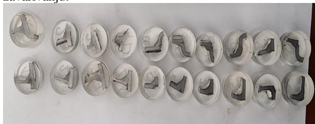
Slika 2. Makro preseki pripremljeni za analizu, s leva na desno 1-10
