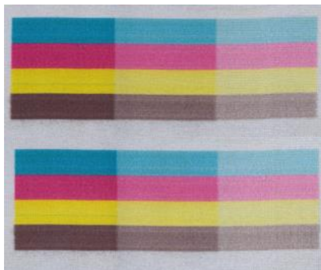
Slika 3. Skenirani uzorci nakon uticaja toplotnog dejstva na materijalu „Gold“
