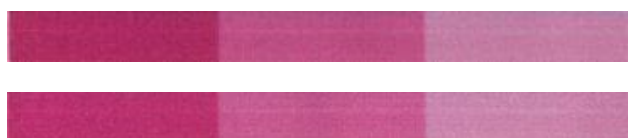
Slika 2. Skenirani uzorci magenta boje nakon uticaja trljanja na materijalu „Gold“
