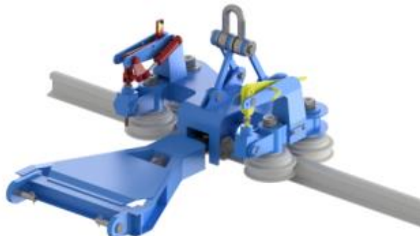
Слика 2. Модификовани уређај за помјерање (црвено - ново конструкционо рјешење, жуто – постојеће рјешење)
