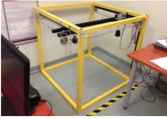
Слика 3. Модел мосне дизалице Универзитета технологије у Талину, Литванија [3]
