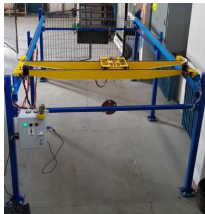
Слика 1. Лабораторијски модел дизалице и дизаличке стазе [1]
