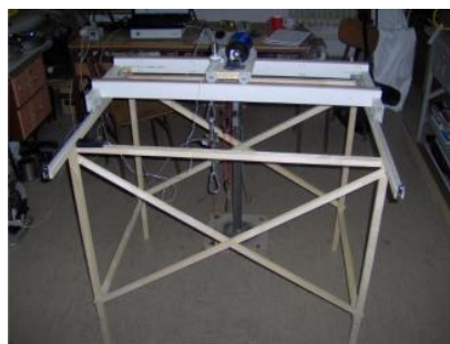
Слика 2. Модел испитне носеће конструкције дизалице Универзитета у Зеници, БиХ [2]
