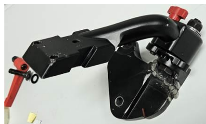
Slika 1. Nosač tračne testere za metal nakon zavarivanja
