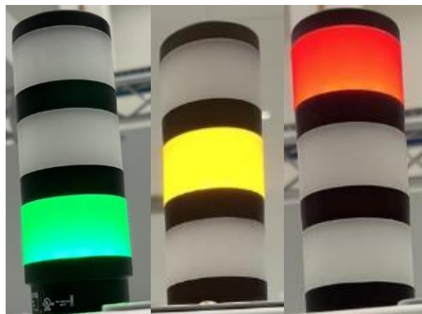
Slika 3. Signalne lampice koje obavještavaju da: a) mašina radi bez zastoja, b) mašina ima problem, c) mašina je zaustavljena
