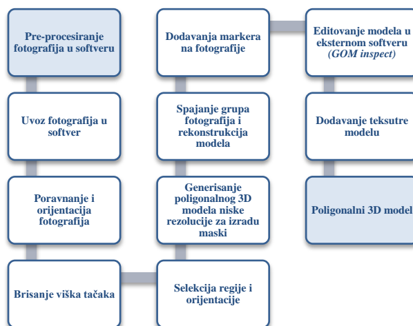
Slika 3. Dijagram toka koraka pre-procesiranja fotografija u softveru
