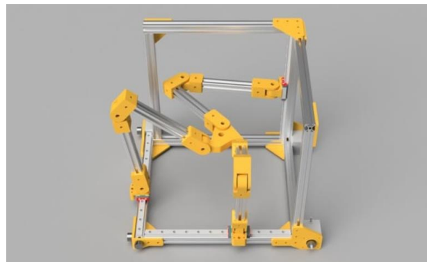
Слика 1. Кинематика декартове паралелне машине
